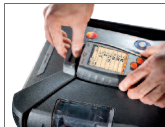
Управляющий модуль просто "защелкивается" в блок анализатора
