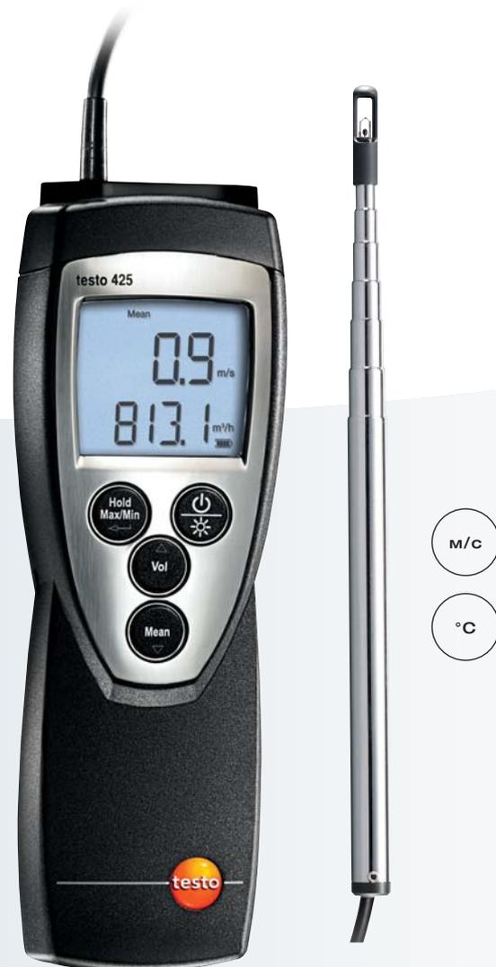
Компактный анемометр testo 425 со стационарно подсоединенным обогреваемым зондом температуры / скорости воздуха. Диаметр наконечника зонда 7.5 мм. Благодаря наличию телескопической рукоятки (макс. длина до 820 мм), прибор идеально подходит для измерения скорости потока в воздуховодах. С помощью testo 425 Вы также можете проводить точные измерения при низких скоростях воздушного потока.
