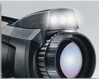
Встроенная цифровая камера с мощной LED-подсветкой
