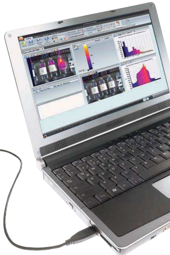
ПО для ПК: функция наложения снимков TwinPix
