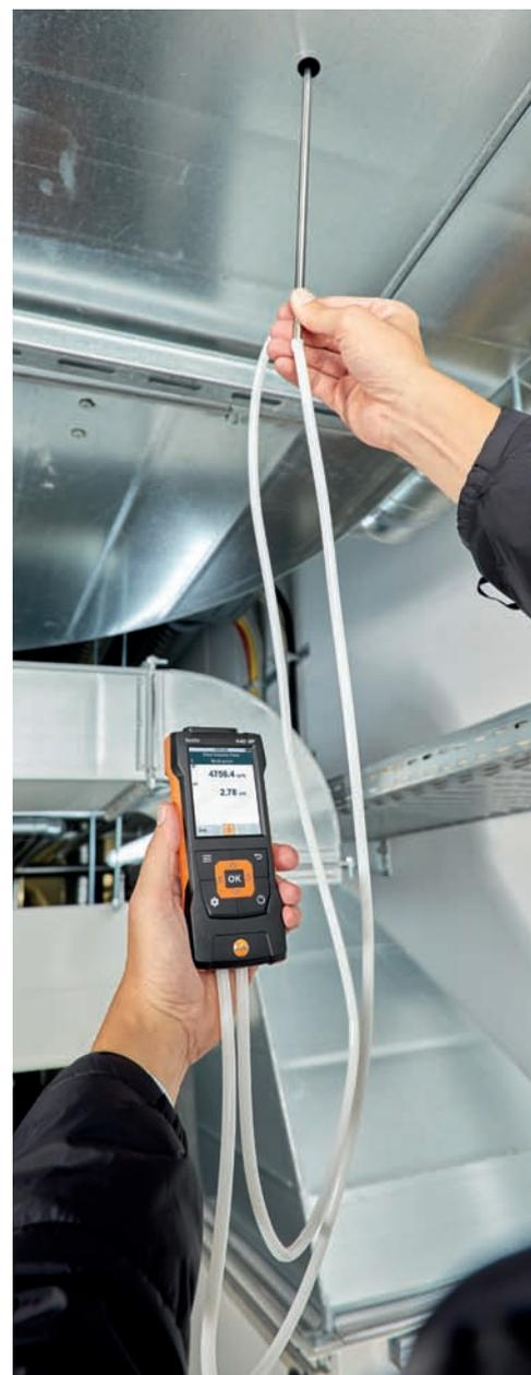
Для измерения объемного расхода при высоких скоростях потока или в сильно загрязненном воздухе мы рекомендуем использовать модель testo 440 dP с трубкой Пито
