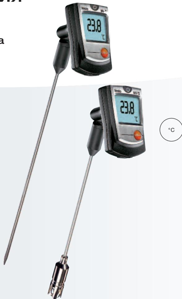
testo 905-T1 – быстродействующий проникающий термометр с широким измерительным диапазоном от -50 до +350 °C, краткосрочно до +500 °C (1-2 минуты). Прибор имеет профессиональный промышленный сенсор (термопара Тип К). Кроме того, термометр обладает высокой точностью измерений, в частности в верхней части измерительного диапазона.
