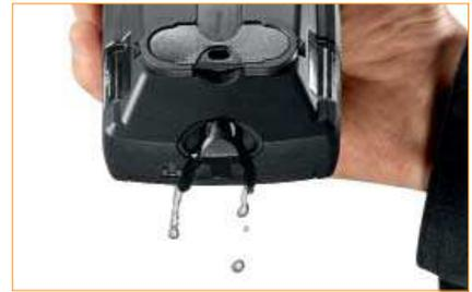
Результаты измерений просто считать с четкого дисплея или передать для распечатки на портативный принтер. Ресурс аккумулятора в testo 310 составляет 10 часов. Прибор прекрасно подходит для измерений в тяжелых условиях. Просто и быстро можно слить конденсат из конденсатоуловителя.
